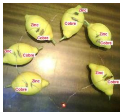
Imagen 1: Ejemplo de montaje con 6 limones
