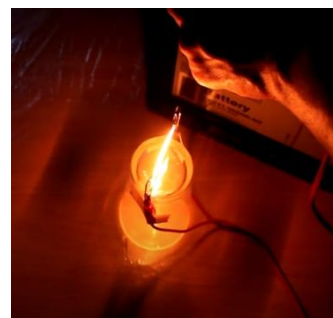
Imagen 1: Barra de grafito emitiendo luz al pasar la corriente eléctrica.
